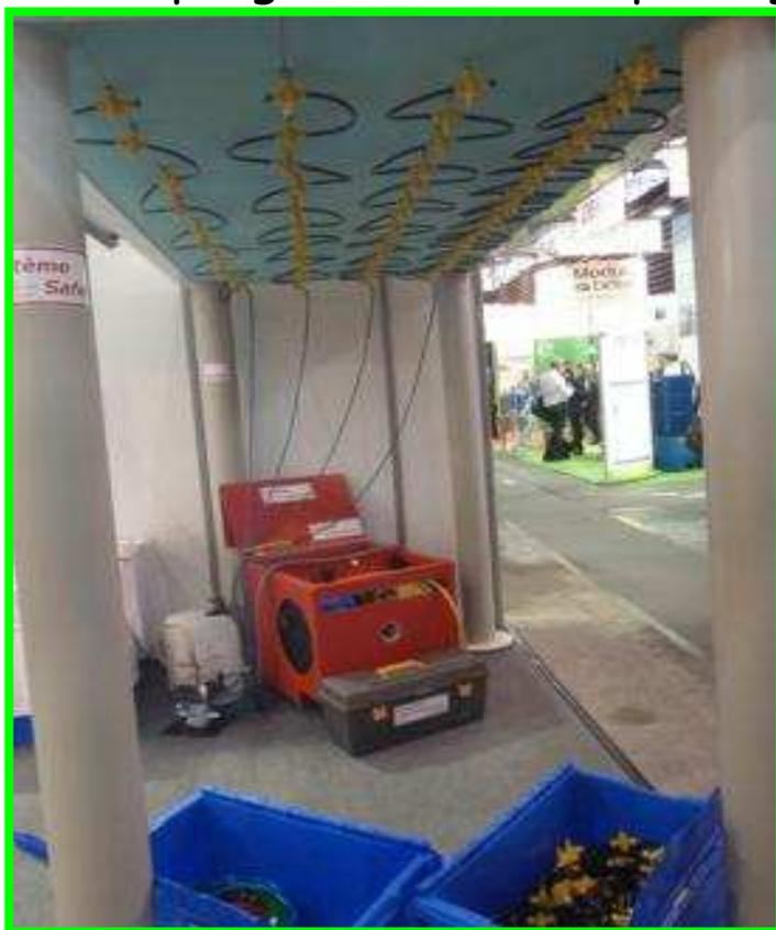
la réserve d'agent mouillant et la pompe alimentant le réseau d'aiguilles
